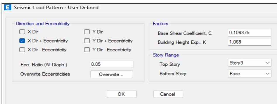
En la Figura 10 se muestra cómo se definió las cargas sísmicas para el análisis estático en donde se introdujo los valores del coeficiente basal y el factor k.
