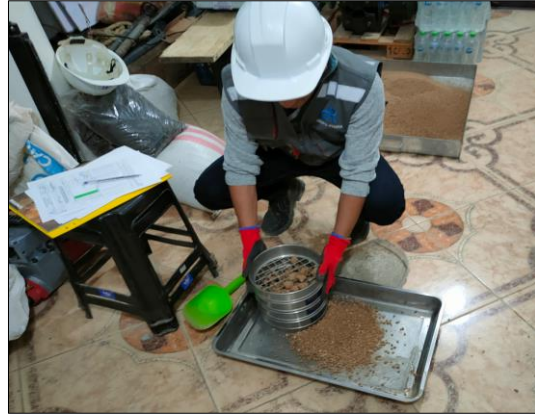
Fotografía 08.- Se observa el desarrollo del ensayo de análisis granulométrico
