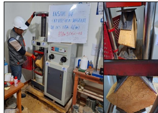
Fotografía 24.- Se observa el desarrollo del ensayo mecánico de compresión diagonal de las muestras (V'm)
