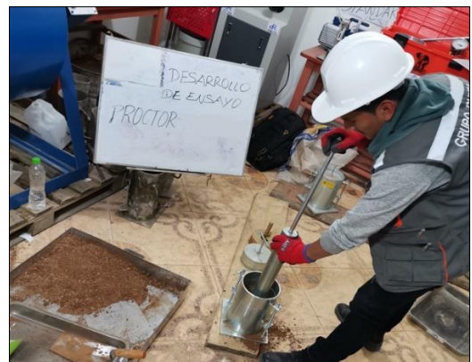
Fotografía 12.- Se observa el desarrollo del ensayo Proctor modificado
