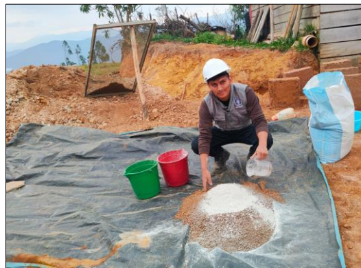
Fotografía 16.- Se observa el mezclado de Suelo y CaO para la elaboración de los especímenes BTA
