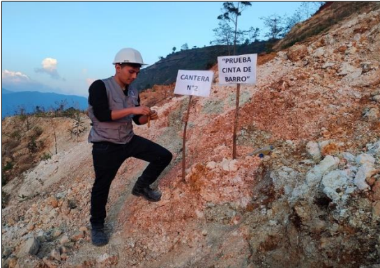
Fotografía 01.- Se observa el desarrollo de las pruebas de campo (Prueba cinta de barro)
