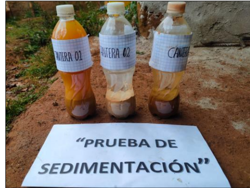
Fotografía 02.- Se observa el desarrollo de las pruebas de campo (Prueba de sedimentación)
