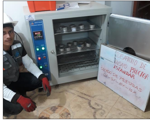
Fotografía 14.- Se observa el secado de las taras para determinar los contenidos de humedad de las muestras en el ensayo Proctor.
