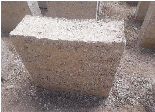
Fotografía 21.- Se observa el espécimen en buen estado típico que contiene CaO en un 5%
