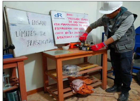
Fotografía 10.- Se observa el desarrollo del ensayo de límites de plasticidad
