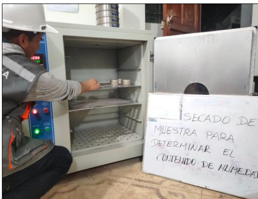
Fotografía 11.- Se observa el secado de las taras para determinar los contenidos de humedad de las muestras.
