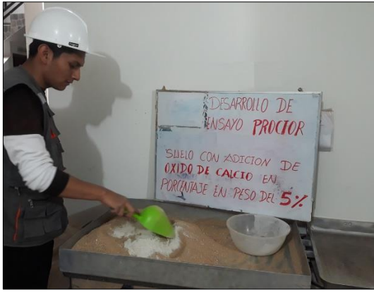
Fotografía 13.- Se observa la mezcla de suelo con adición de CaO para realizar el ensayo Proctor.
