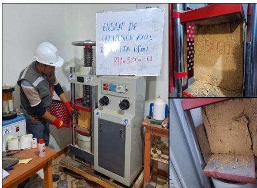
Fotografía 23.- Se observa el desarrollo del ensayo mecánico de compresión axial de las muestras (F'm)
