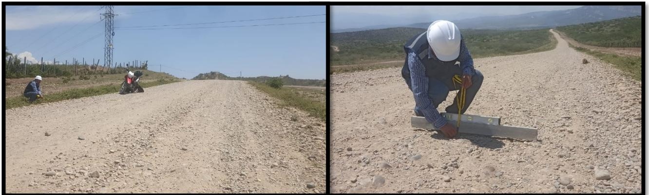
Figura 9. Recolección de datos de condición vial
