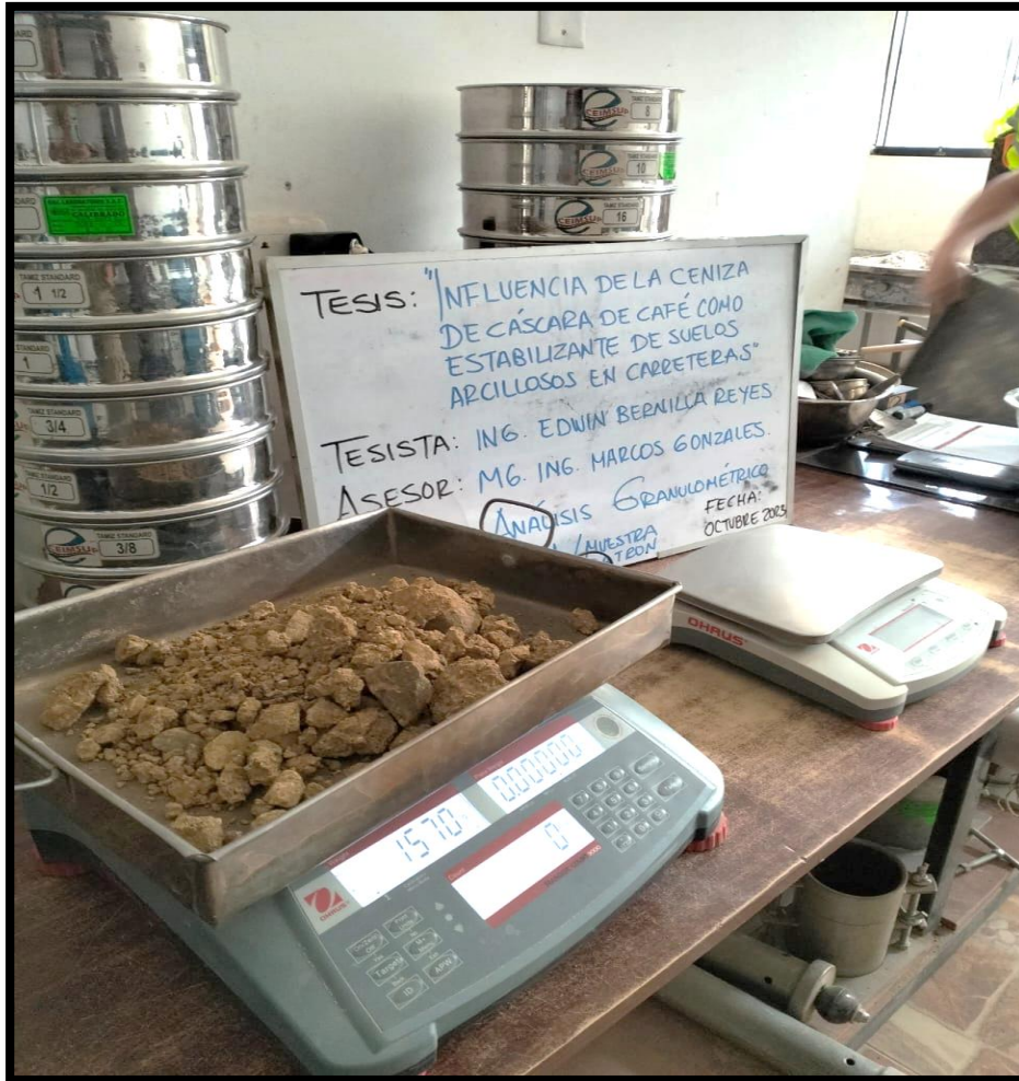
Fotográfica n° 29: Se realizó el peso de la muestra para ensayo granulométrico.
