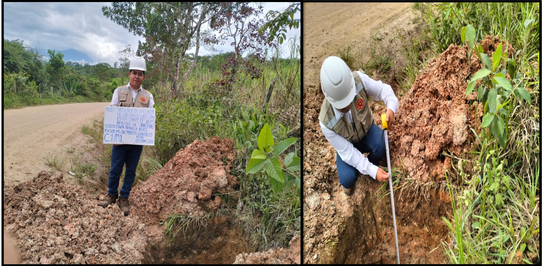
Fotográfica n° 02: Se realizó medición de excavación de calicata N° 01 y muestra 1.
