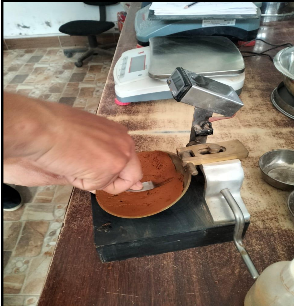
Fotográfica n° 37: Muestra homogénea se procedió a colocar el ranurador de bronce y se obtuvo la ranura en la muestra arcillosa.
