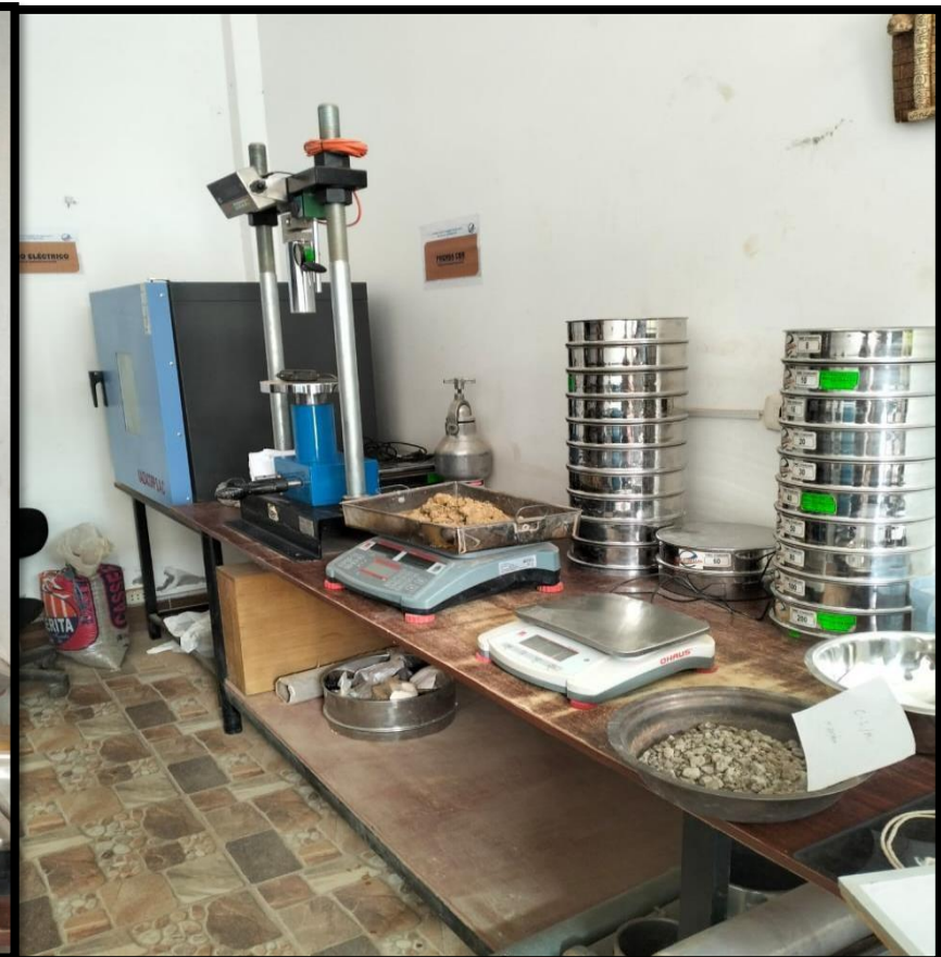
Fotográfica n° 28: Equipos y materiales que se usaron en los ensayos de laboratorio.
