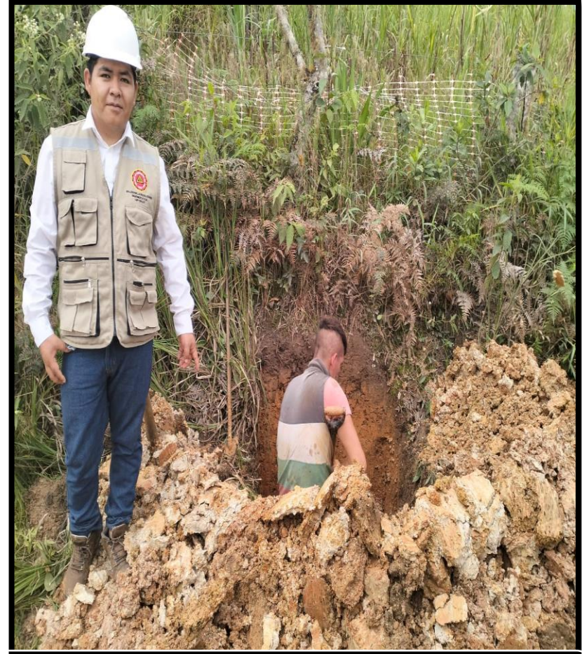
Fotográfica n° 16: Evaluación de trabajos de excavación a cielo abierto en las calicatas y toma de muestra para laboratorio.
