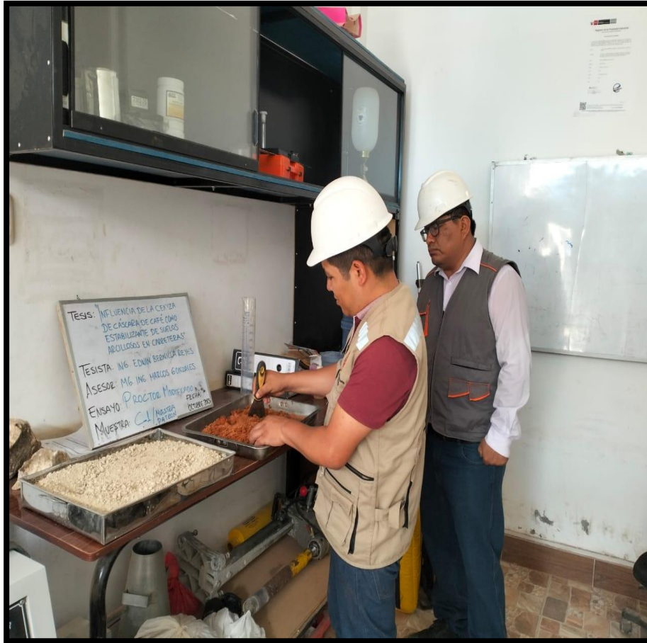
Fotográfica n° 47: Mezclado del material para lograr muestra homogénea y trabajable, con la supervisión del asesor.
