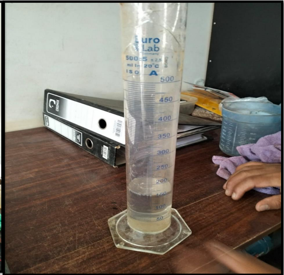
Fotográfica n° 46: Medición de porcentaje (%) de agua para colocar en la muestra.
