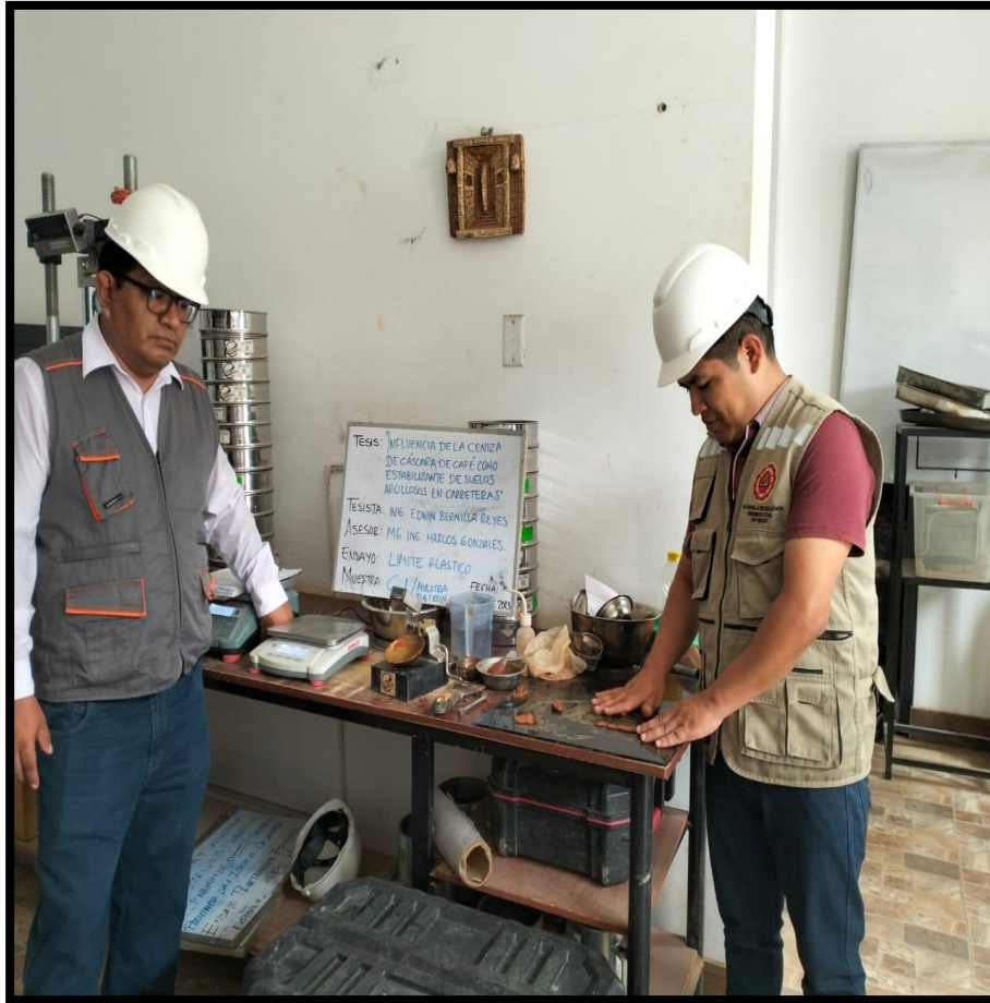
Fotográfica n° 41: Se observa realizando ensayos de límite líquido plástico, con la participación del asesor.
