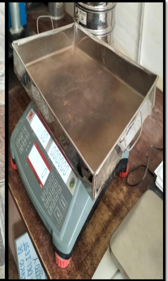
Fotográfica n° 44: Se observan los equipos utilizados para el ensayo de Proctor Modificado.
