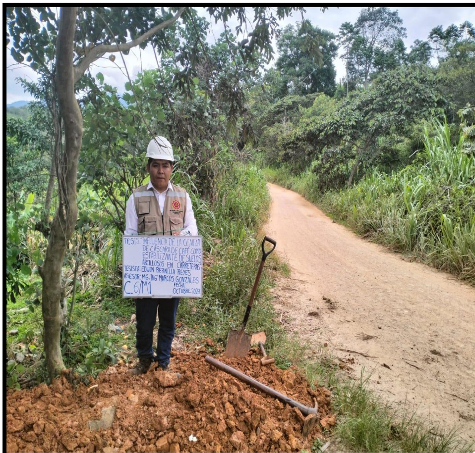
Fotográfica n° 11: Se procedió a la comprobación de la profundidad (1.50m) en la calicata N° 06, ubicada en la progresiva (Km 6+500).
