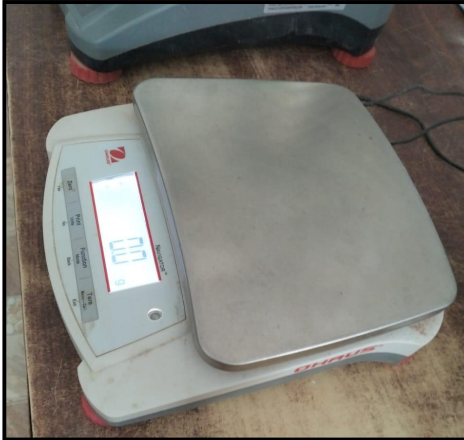
Fotografía n° 35: Para la ejecución de este ensayo se contó con una balanza con una precisión de 0.01g y una capacidad de 6.00 kg.
