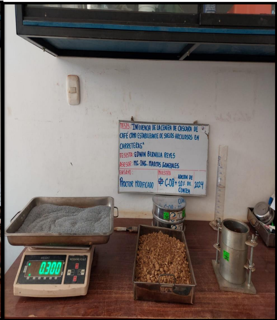
Fotográfica n° 50: Se observa la dosificación entre la muestra de suelo y cáscara de ceniza de café.
