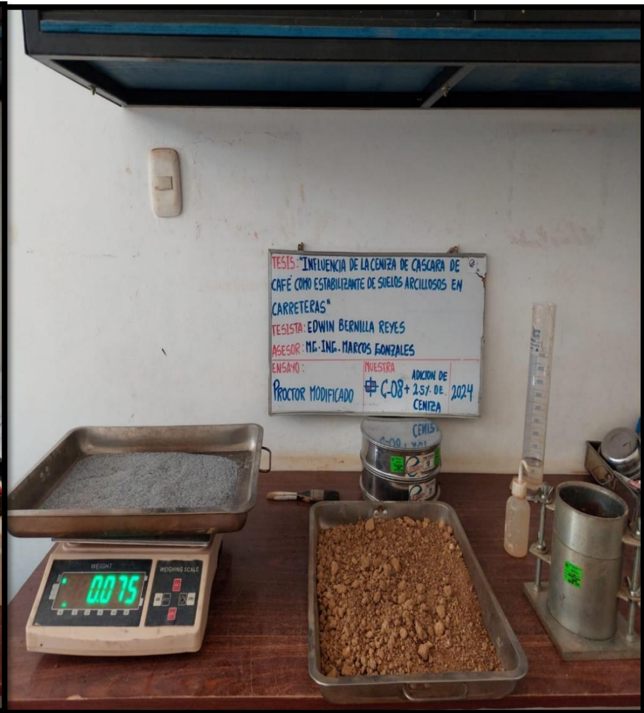
Fotográfica n° 52: Se observa la dosificación al 2.5% de ceniza de cáscara de café.
