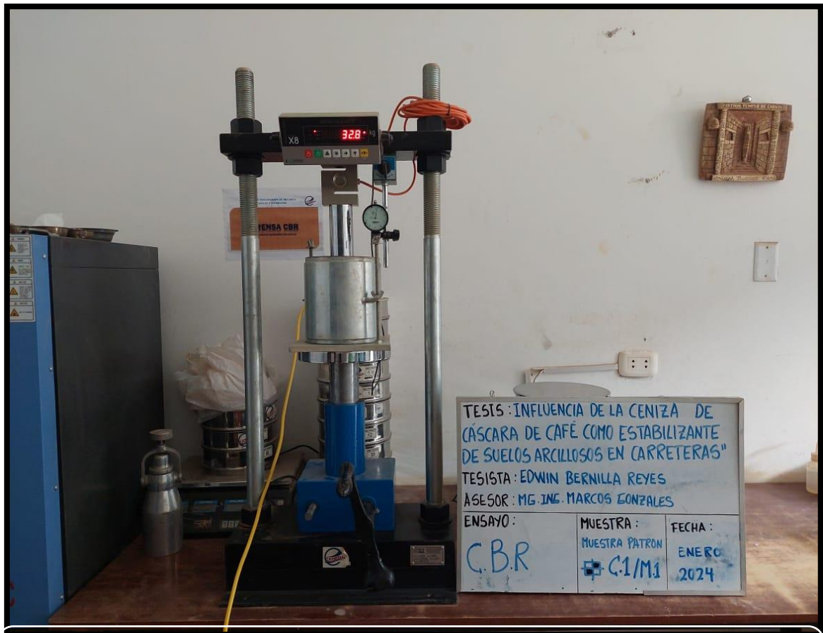
Fotográfica n° 59: Luego de haber verificado la precisión requerida se procedió a la rotura de las muestras de los CBR.
