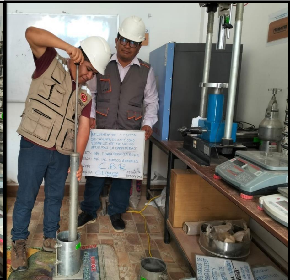
Fotográfica n° 56: Se realizó el moldeo del CBR, la compactación de 5 capas de 25 y 56 golpes por capa en forma de espiral en los 2 moldes correspondientes.
