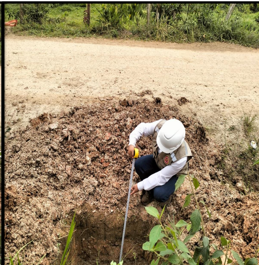
Fotográfica n° 22: Se realizó la medición de excavación de calicata N° 10 y muestra 1, profundidad 1.50m, ubicado en la progresiva (Km
