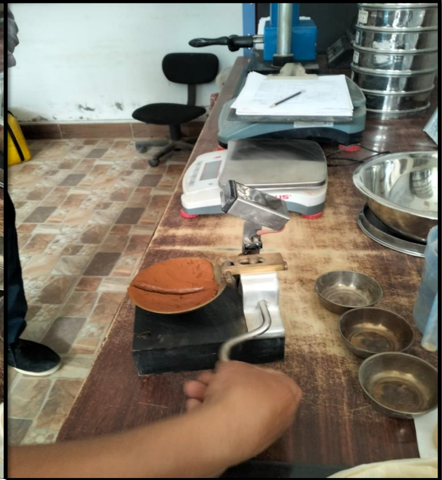
Fotográfica n° 38: A continuación, se realizó el número de golpes para el cierre de la ranura hasta \frac{1}{2} ".
