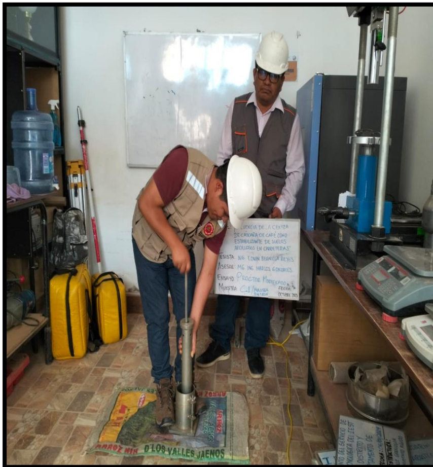
Fotográfica n° 53: Se observa la ejecución del ensayo de Proctor modificado por el método A de la norma MTC-115.
