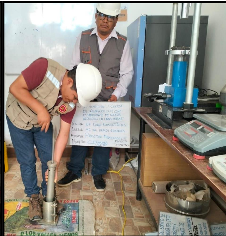
Fotográfica n° 54: Se observa realizando los 25 golpes de la tercera, cuarta y quinta capa de la muestra del Proctor modificado.
