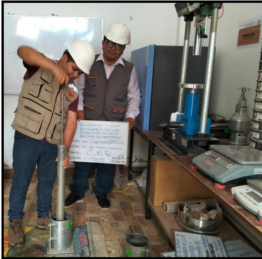
Fotográfica n° 55: Se realizó el moldeo del CBR, la compactación de 5 capas de 12 golpes por capa en forma de espiral en el primer molde.
