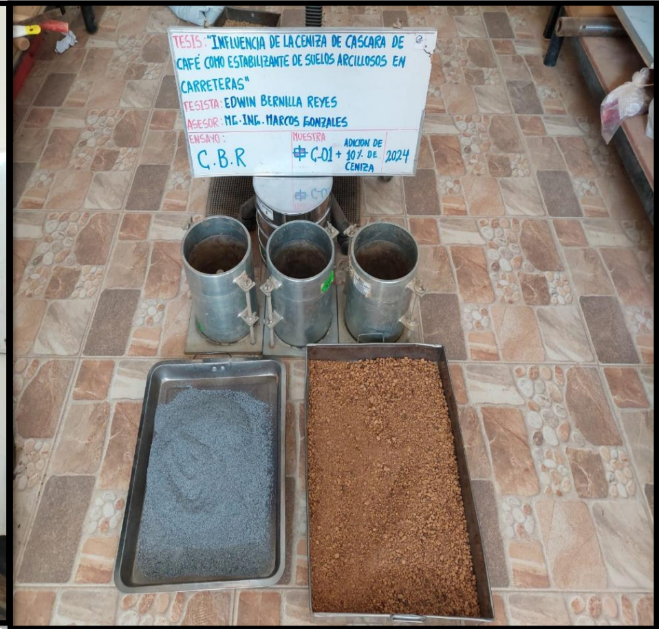
Fotográfica n° 48: Se observa las proporciones de la combinación para ser moldeados y los moldes.
