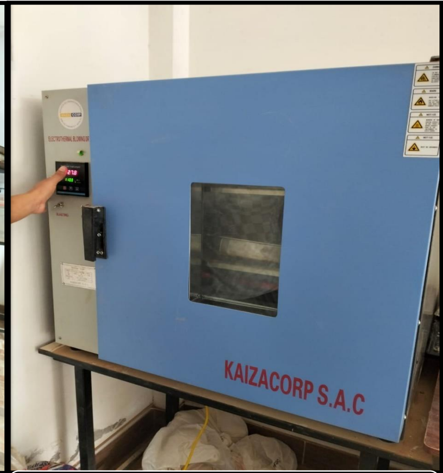
Fotográfica n° 40: Colocación de la muestra en el horno por un lapso de 24 horas a 110°.
