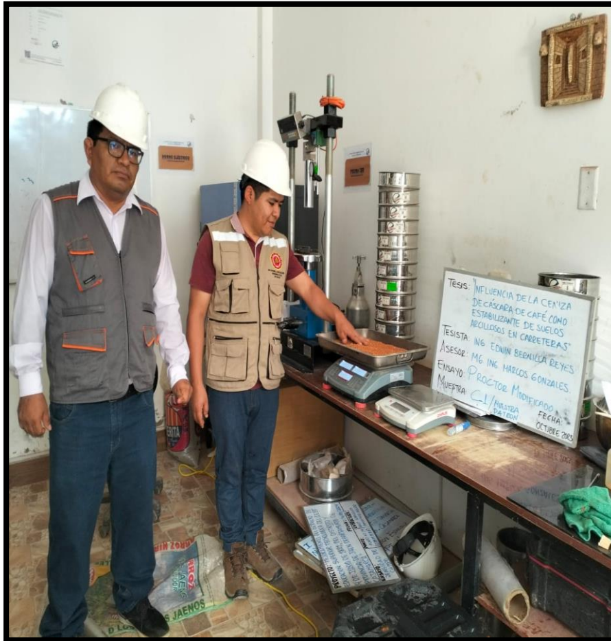
Fotográfica n° 45: Se observa realizando el pesado de la muestra para el ensayo del Proctor Modificado, Método A, con la supervisión del asesor.
