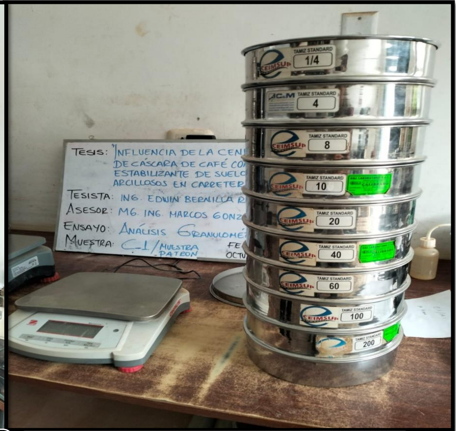
Fotográfica n° 32: Ejecución de ensayo de análisis granulométrico en la calicata C-1 (muestra patrón)
