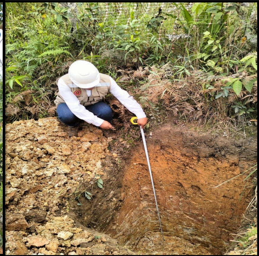
Fotográfica n° 24: Verificando los trabajos realizados en la calicata N° 12, profundidad 1.50m, en la progresiva (Km 9+500).
