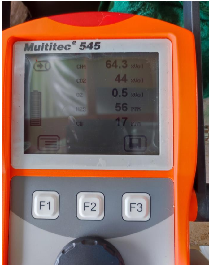
Fotografía 9. Uso del Equipo MultiTec 545 para la medición de los parámetros del biogás
