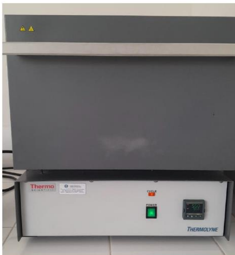
Fotografía 5. Uso de Mufla para la calcinación de la muestra a 550 °C
