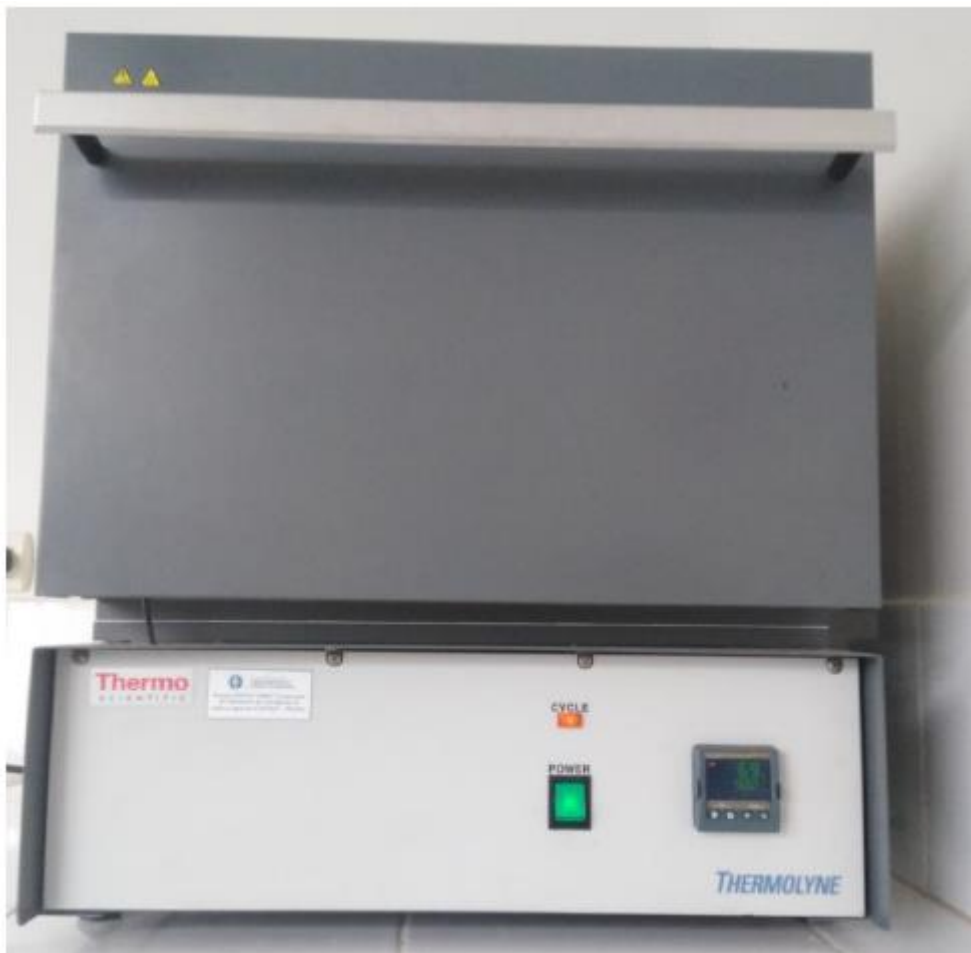
Fotografía 4. Calcinación de la muestra a temperaturas de 900°C y 550 °C
