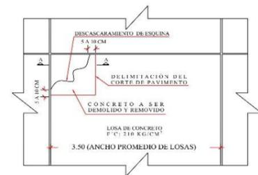
LA ZONA AFECTADA DEBE SER MARCADA PARA SU POSTERIOR CORTE, PARA ESTO DEBE TENER EN CONSIDERACIÓN QUE LA DELIMITACIÓN DE LA ZONA DE CORTE DEBE EXTENDERSE ENTRE 5 A 10 CM DEL ÁREA DETERIORADA, LUEGO SE PROCEDE A LA DEMOLICIÓN Y RETIRO DE ESCOMBROS DEL CONCRETO.
