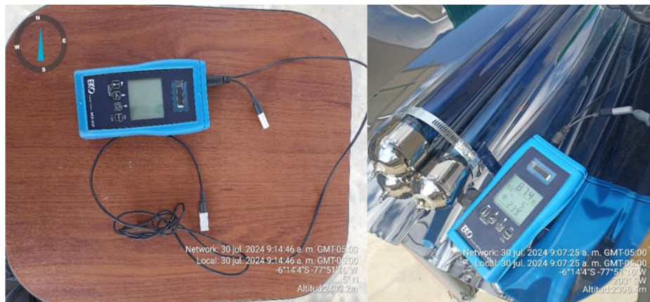
Figura 11. Piranómetro Digital EKO MS-02
