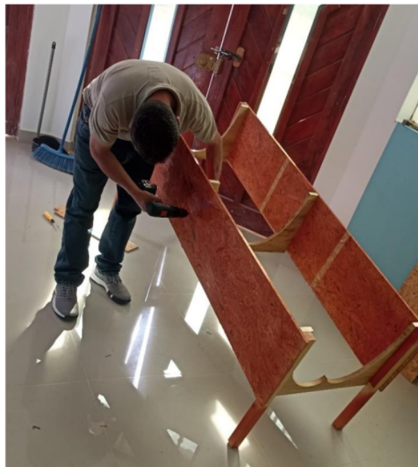
Figura 8. Armazón de madera del prototipo de cocina solar
