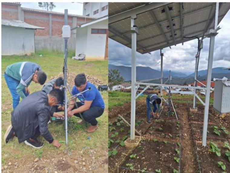
**Figura 11.** Instalación de una estación agrometeorológica
