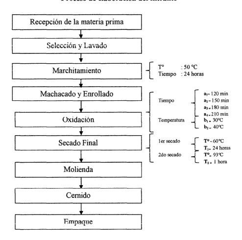
Figura 2. Diagrama de flujo del proceso para la obtención del filtrante a partir de hojas y tallos tiernos de congona (*Peperomia inaequalifolia*).
