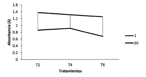
**Figura 8.** Evaluación del color de los mejores tratamientos del filtrante de congona, a la longitud de onda de 380nm, evaluados a los 01 y 30 días, sometidos a temperatura de 26°C y humedad relativa de 56%.
