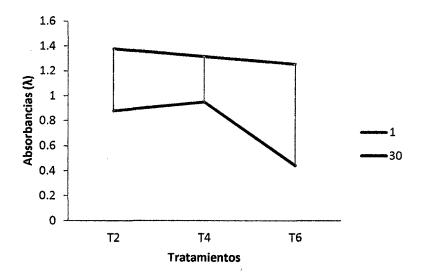
**Figura 10.** Evaluación del color de los mejores tratamientos del filtrante de congona, a la longitud de onda de 380 nm, evaluados a los 01 y 30 días, sometidos 50 °C de temperatura y 45% de humedad relativa.
