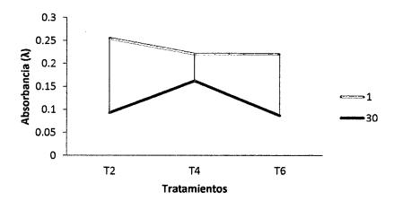
**Figura 10.** Evaluación del color de los mejores tratamientos del filtrante de congona, a la longitud de onda de 480 nm, evaluados a los 01 y 30 días, sometidos 26°C de temperatura y 56% de humedad relativa.
