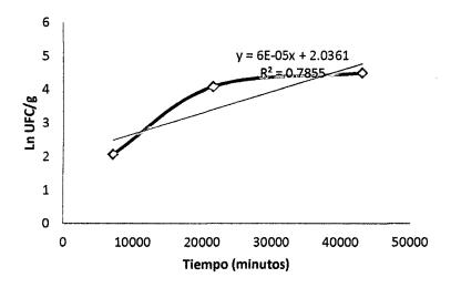
**Figura 12** Logaritmo natural de las unidades formadoras de colonias por gramo vs el tiempo a la temperatura de 26°C.
