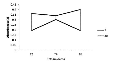
**Figura 9.** Evaluación del color de los mejores tratamientos del filtrante de congona, a la longitud de onda de 430 nm, evaluados a los 01 y 30 días, sometidos a temperatura de 26°C y humedad relativa de 56%.
