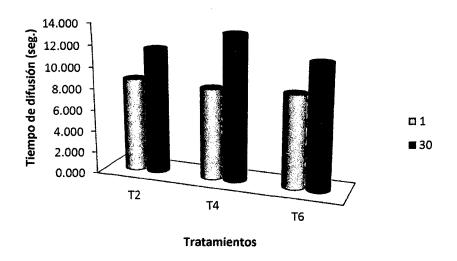
**Figura 11.** Evaluación del tiempo de difusión de los mejores tratamientos del filtrante de congona, evaluados a los 01 y 30 días, sometidos a 50°C de temperatura y 45% de humedad relativa.
